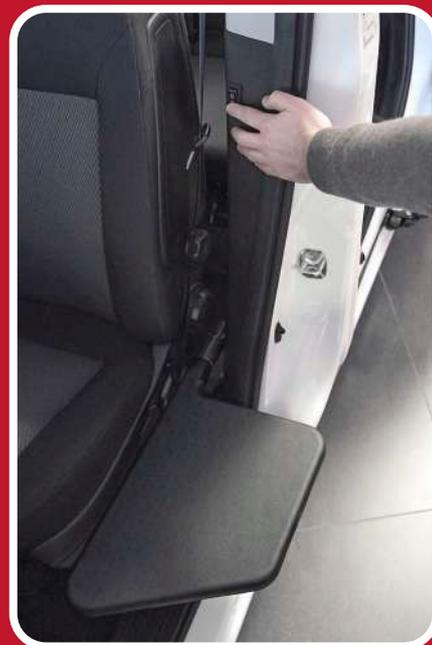
La ribaltina è facilmente rimovibile. Un sistema di sicurezza fermerà automaticamente la salita e la discesa della ribaltina in caso di emergenza. La capacità massima di sollevamento del dispositivo è di 100 kg.
